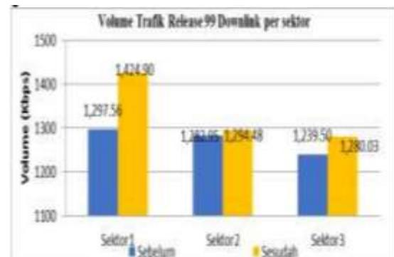
Gambar 13. Volume trafik rata-rata release 99 per sektor Downlink setelah 2nd carrier
