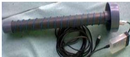
Gambar 6. Antena helix yang siap di uji coba
