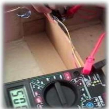
Gambar 9. Pengujian sensor LDR
