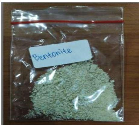
Gambar 8. Bentonite untuk pengujian
