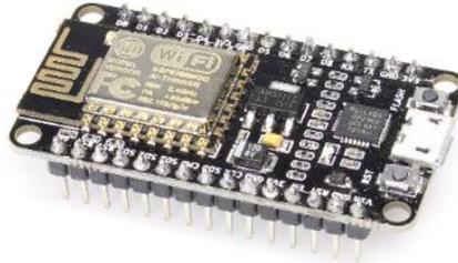
Gambar 2. NodeMCU ESP 8266
