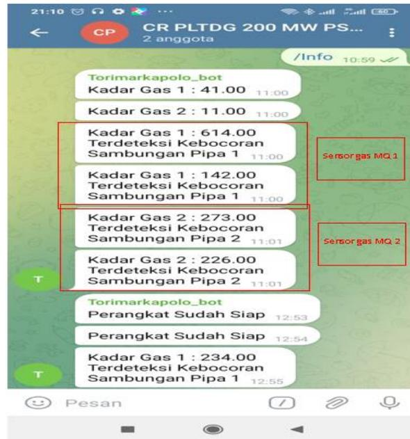
Gambar 17. Hasil Pengujian keseluruhan perangkat Notifikasi telegram
